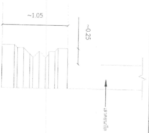
แบบขยายฐานปัทม์ NO SCALE
